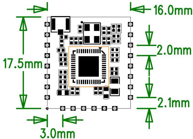
图 4 RTL01 模组尺寸平面面图
